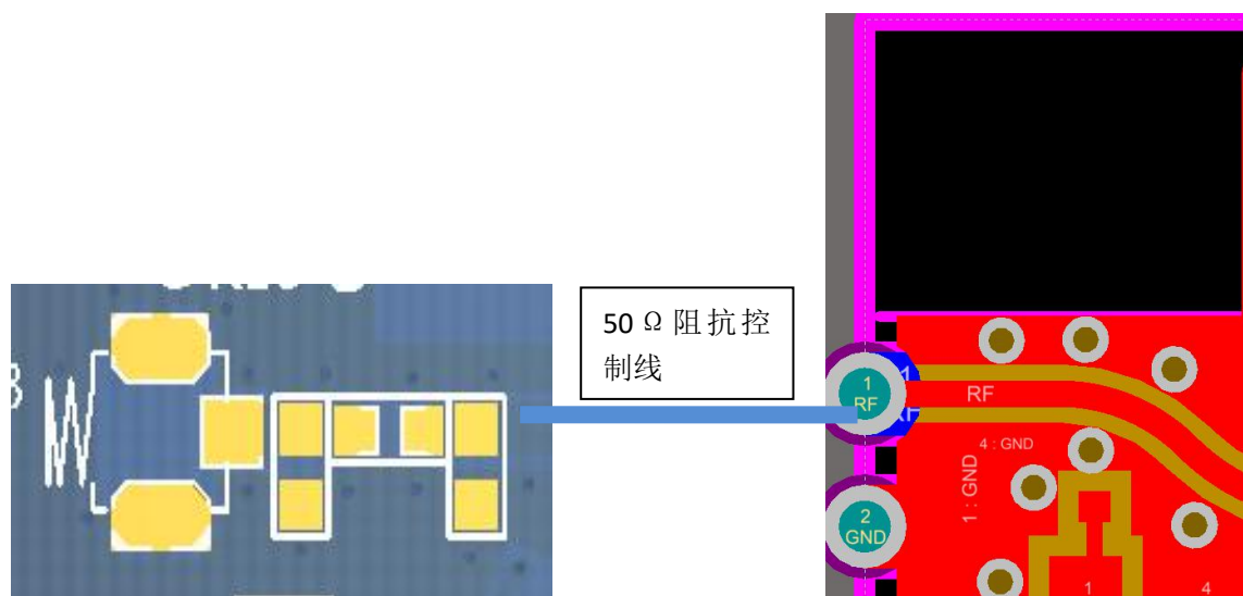
图 4-2 外置天线连接示意(SMA 或者 IPEX)
